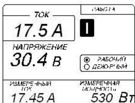
Рис. 7. Вид ЖК дисплея при включенной стабилизации по току
