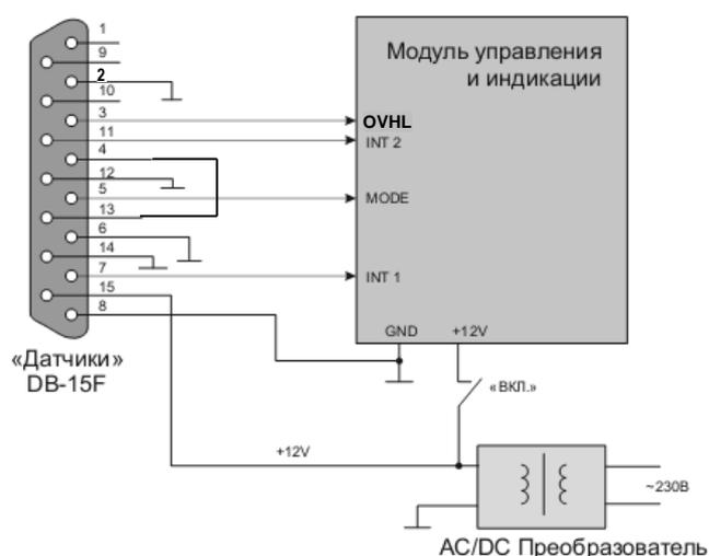
Рис. 8. Схема цепей входных управляющих сигналов разъема "УПРАВЛЕНИЕ".
