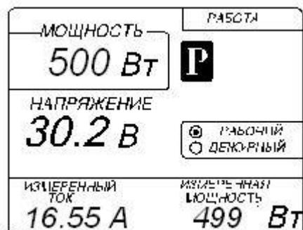
Рис. 6. Вид ЖК-дисплея при включенной стабилизации по мощности
